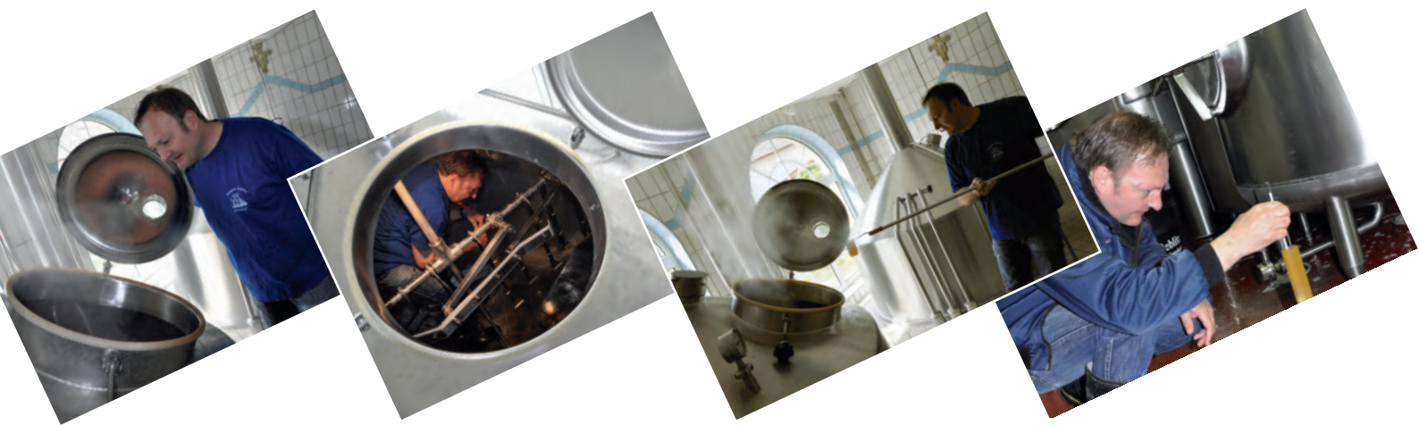
Der Senior-Chef in Aktion: Vor dem Brauvorgang ist die akribische Reinigung angesagt. Dazu muss der Brauer auch in die Edelstahlkessel klettern. Während des Brauvorgangs wird auch die Stammwürze immer wieder kontrolliert.
